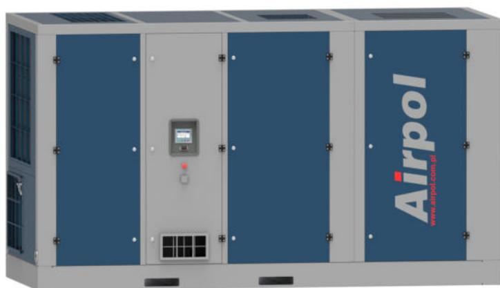
Интегрированная система очистки сжатого воздуха удаляет влагу до требуемой точки росы + 3°C и обеспечивает остаточное содержание масла в сжатом воздухе, обеспечивая качество воздуха на уровне класса чистоты 2.4.2 (согласно ISO 8573-1). Повышенный класс чистоты воздуха означает мин. более длительный срок службы пневматических инструментов, уменьшение коррозии в системе сжатого воздуха, минимизация риска повреждения конечного продукта, например, лакокрасочного покрытия.
